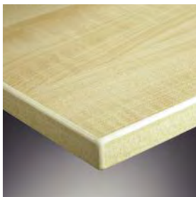
DBS-Tischplatte: Standard-Tischplatte, 19 mm stark als direktbeschichtete Spanplatte mit Holz- oder Unidekor und Umleimer.
