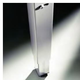
Höheneinstellung COMFORT: Diese Verstellung im 10-mm-Raster für Quadratrohrtische ist besonders bedienungsfreundlich und bietet die vielfach geforderte Einstellhöhe von 620 – 850 mm.
