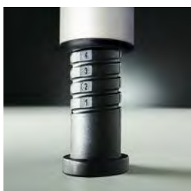
Höheneinstellung BASIC: Als preisgünstige Aufrüstooption ist diese Höheneinstellung für Rund- und Quadratrohrtische lieferbar. Durch stufenloses Verstellen der stabilen Kunststoffhülse ist die Tischhöhe von 680 - 780 mm einstellbar.
