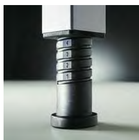
Höheneinstellung BASIC: Als preisgünstige Aufrüstooption ist diese Höheneinstellung für Rund- und Quadratrohrtische lieferbar. Durch stufenloses Verstellen der stabilen Kunststoffhülse ist die Tischhöhe von 680 - 780 mm einstellbar.
