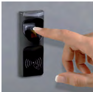
PDN-Schließsystem mit zentralem Bedien-Terminal: Nicht nur die Information über verfügbare freie Fächer, sondern auch die Öffnung des Faches erfolgt am zentralen Bedien-Terminal – und zwar entweder mit dem Datenträger oder mittels des Fingerabdruckes durch einen Biometrie-Leser.
