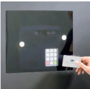
PDN-Schließsystem mit zentralem Bedien-Terminal: Nicht nur die Information über verfügbare freie Fächer, sondern auch die Öffnung des Faches erfolgt am zentralen Bedien-Terminal – und zwar entweder mit dem Datenträger oder mittels des Fingerabdruckes durch einen Biometrie-Leser.
