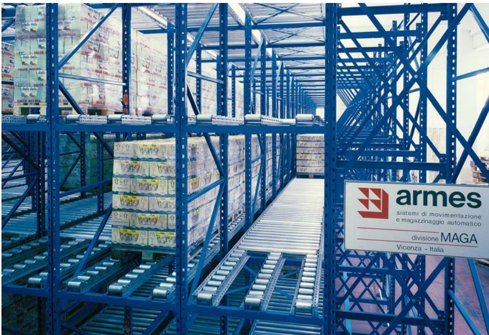
Ein-/Ausführung mit 3 Rollenleisten
