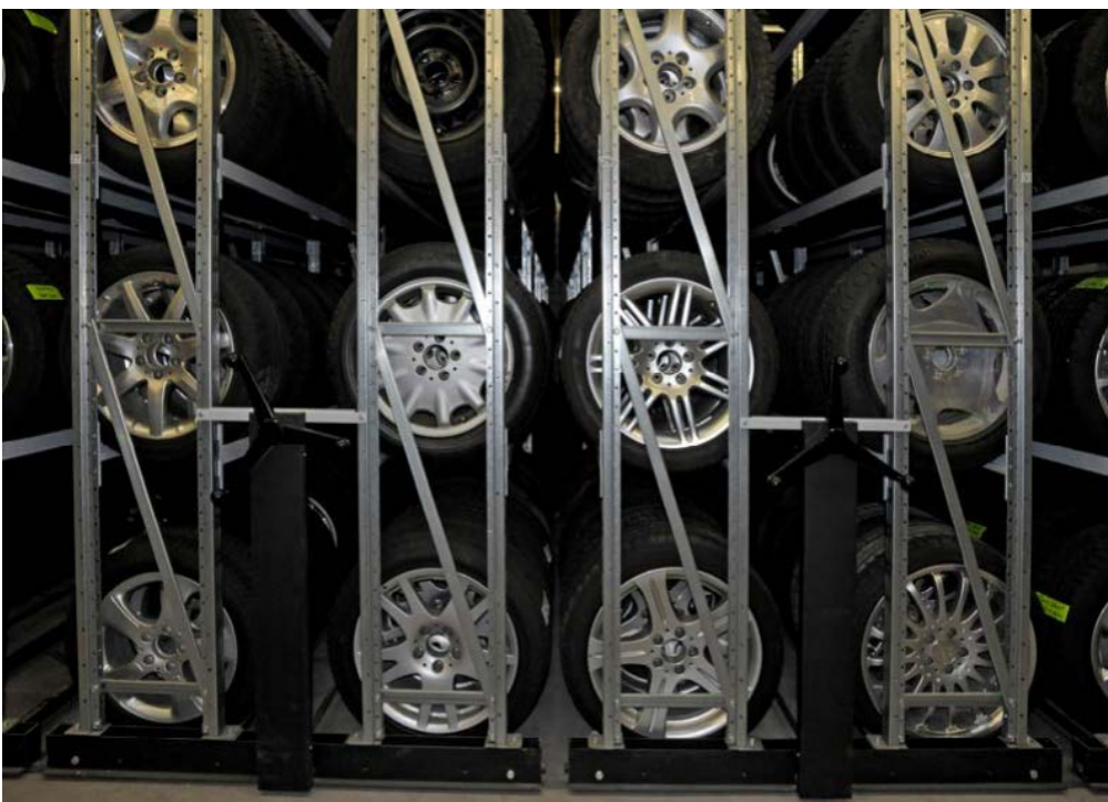
Oben pulverbeschichtete, verschweisste Rahmen, unten verzinkte Rahmen
