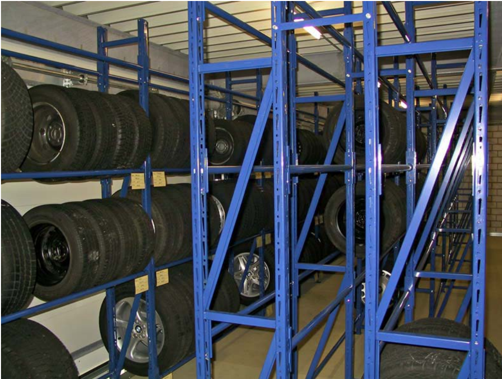
Oben pulverbeschichtete, verschweisste Rahmen, unten verzinkte Rahmen
